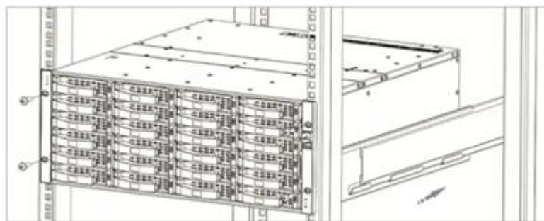
图4-13 安装 SPU 示意图
