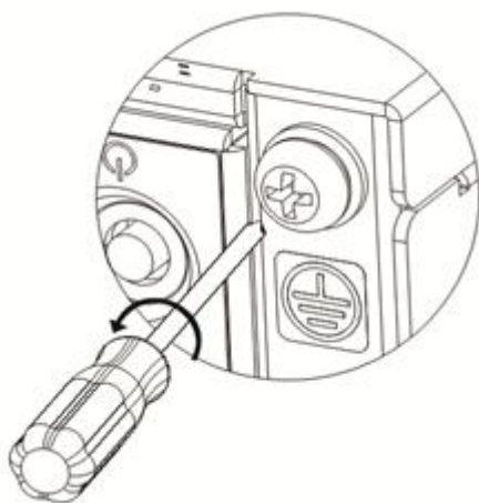
图4-23 松开设备接地端子的螺钉示意图
