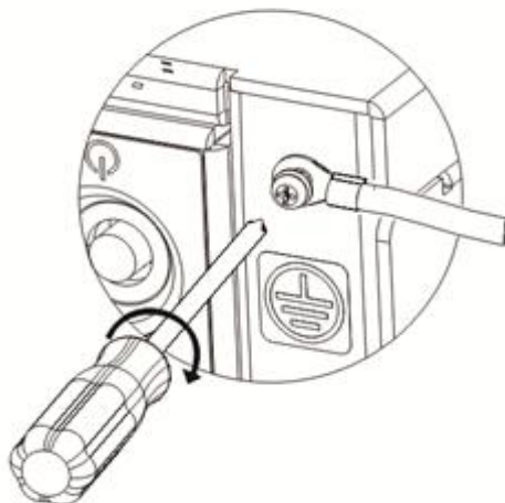
图4-24 安装接地线示意图
